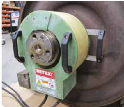
Erwärmung eines Lagerrings zur Demontage
