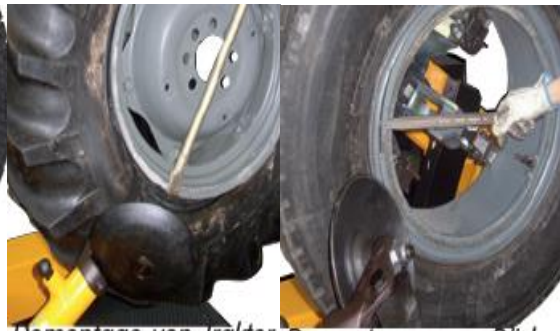
Demontage von Traktor- räder mit Haftwerkzeug mit Soaltrina
