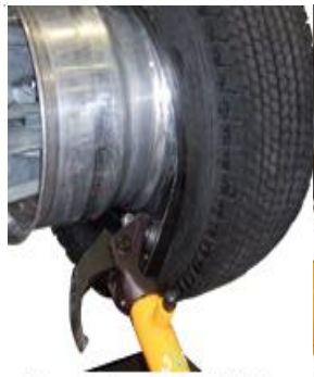
Demontieren mit Platte
