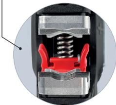
Parabelförmige Messer trennen erst die Isolation, und ziehen diese dann automatisch nach hinten ab
