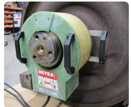
Erwärmung eines Lagerrings zur Demontage
