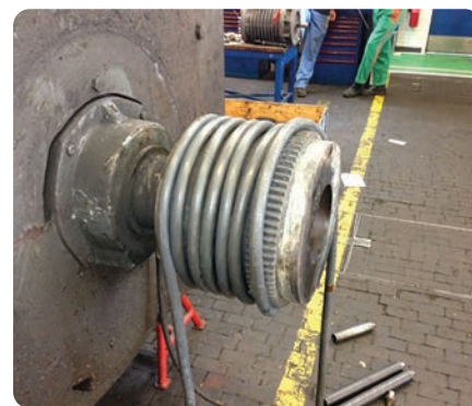
Erwärmung einer Kupplung zur Demontage
