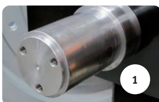
Montage von TBU / SP / Tarol-Lagersätzen in Einzelschritten
