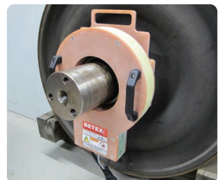
Erwärmung eines Labyrinthrings zur Demontage
