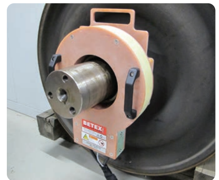
Erwärmung eines Labyrinthrings zur Demontage
