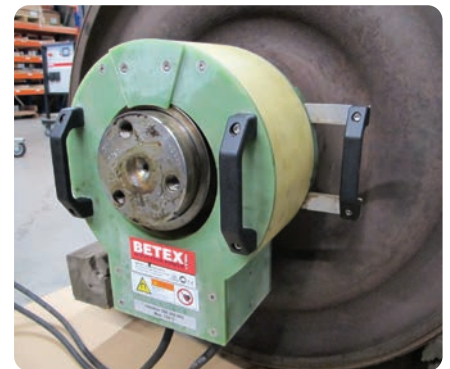
Erwärmung eines Lagerrings zur Demontage
