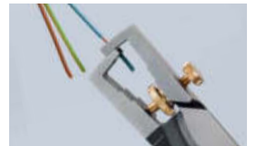
Längenmarkierung durch Stufen unterstützt beim wiederholten Abisolieren gängiger Längen (11 mm und 16 mm)
