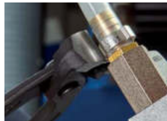
10 98 1220: Abdichten Schlauchanschluss an Zentralschmierung
