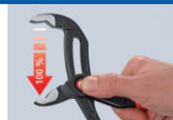
Knopf drücken – Zange vollständig öffnen
