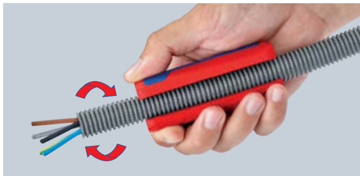
Einfache Handhabung: KNIPEX TwistCut zusammendrücken, mit leichtem Druck drehen, fertig
